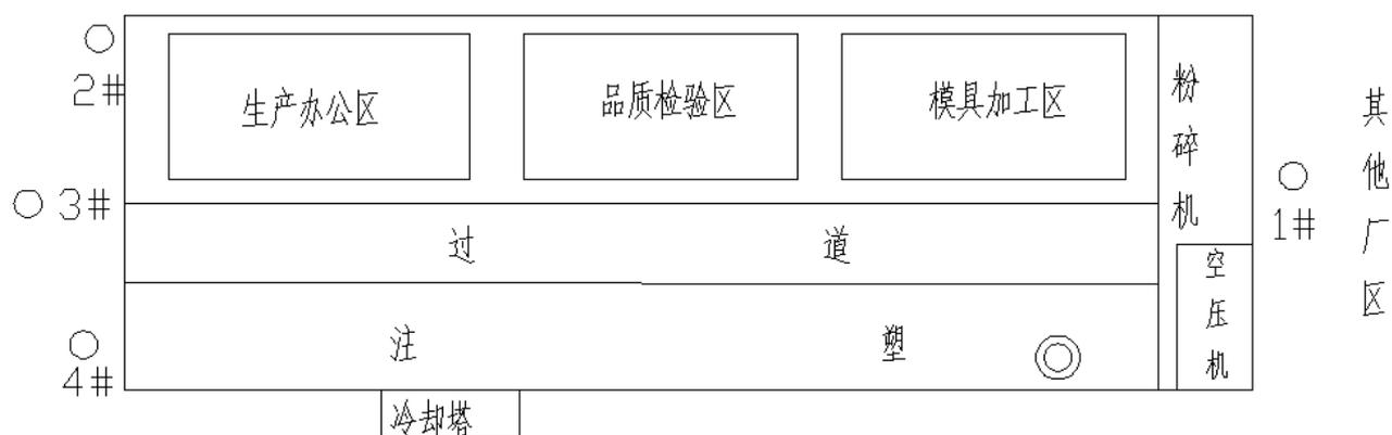
注：⊙为有组织废气监测点；○为无组织废气监测点
