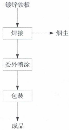
镀锌铁板为原料的生产工序
