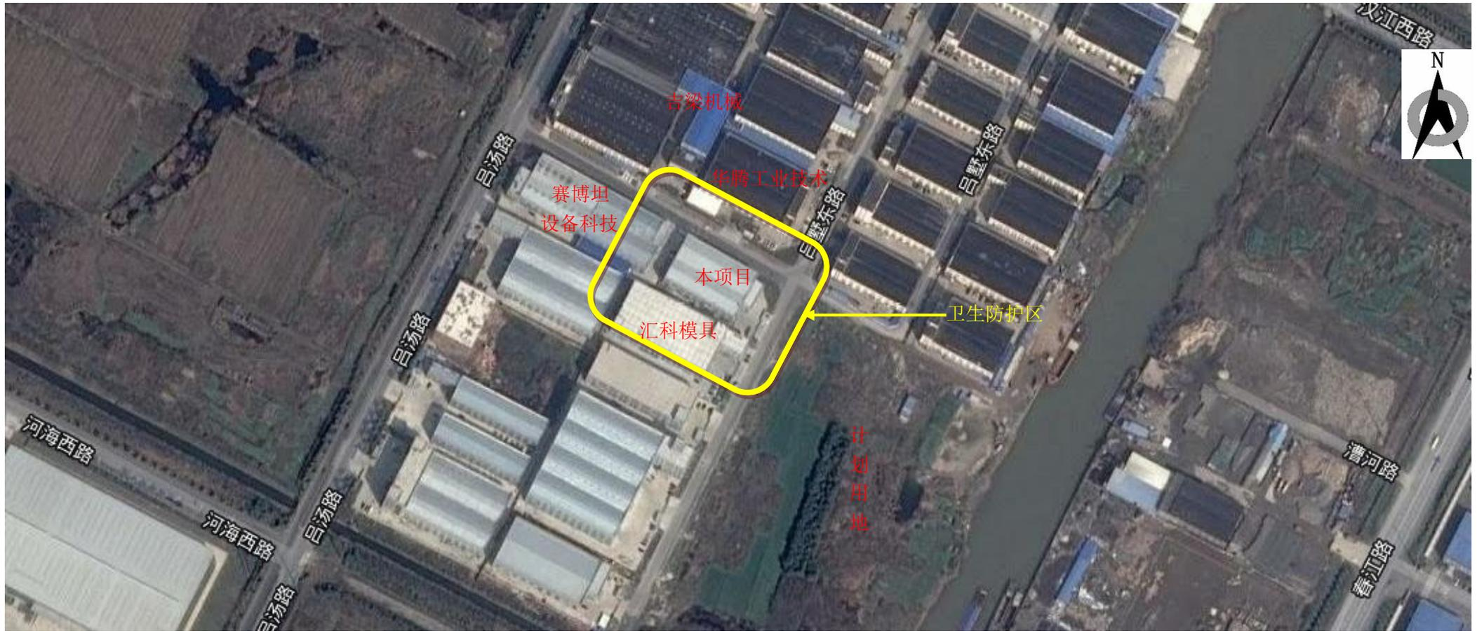
说明：本项目卫生防护距离为生产车间外扩 50 米的包络线，图中线圈即为卫生防护距离，根据现场勘察，此范围内无居民等环境保护敏感点。
