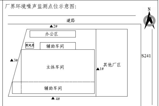
噪声监测点 位布设(示意 图)监测结果
