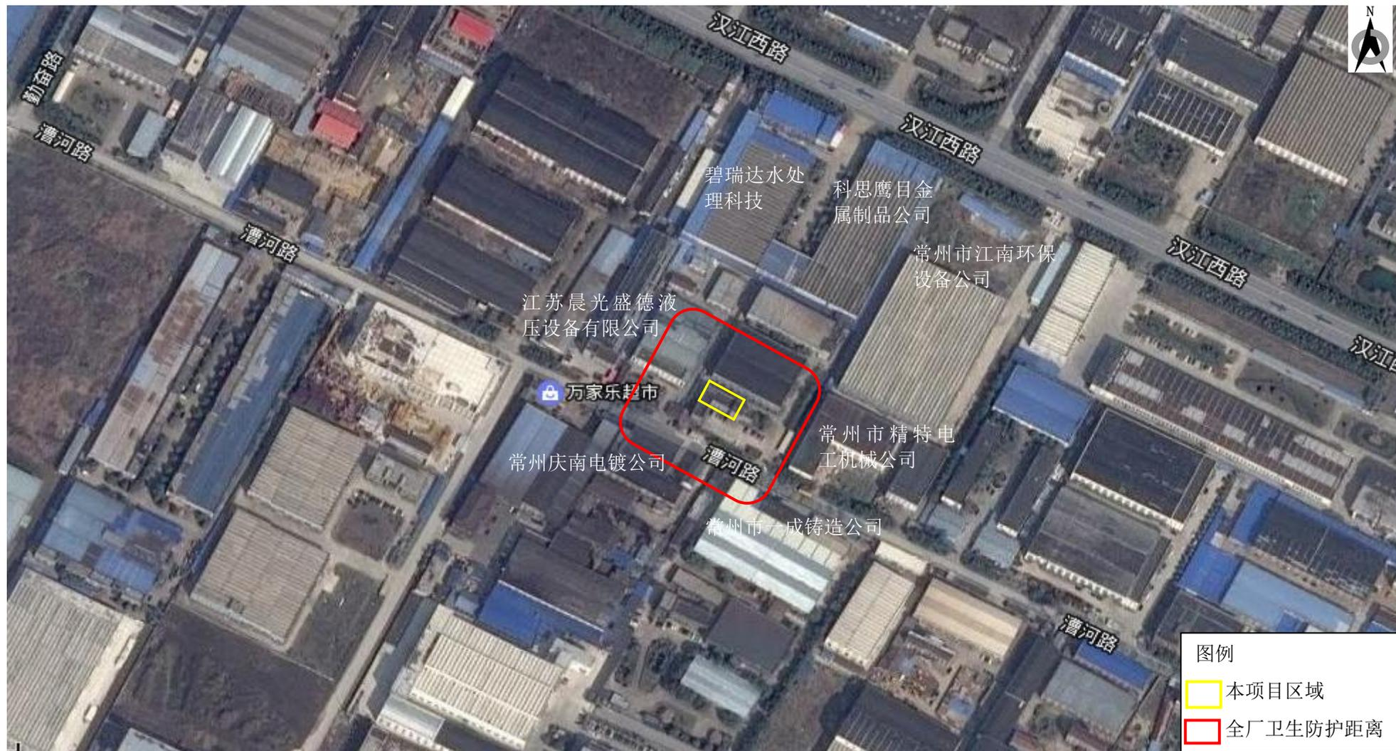
说明：本项目卫生防护距离为生产车间边界外扩 50 米形成的包络区域，上图外圈为全厂卫生防护距离范围图示，根据现场核查，目前该范围内无居民等敏感点。
