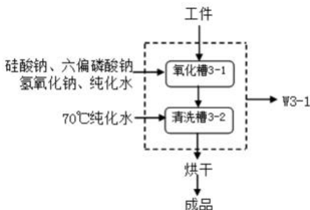
图 3-5 硬膜氧化工艺流程图
